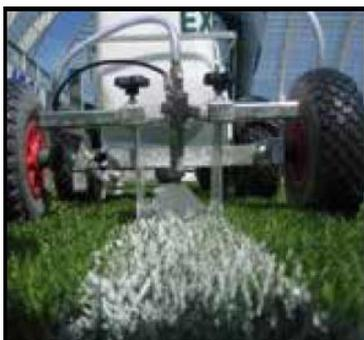
La hauteur idéale du gicleur est de 10 centimètres. Les particules de peinture doivent à peine toucher le bas des plaquettes de délimitation. Si le pistolet est placé trop haut, vous obtenez deux jets de peinture coulante. Si le pistolet est trop bas, la ligne sera trop fine. La photo montre un bel exemple.
